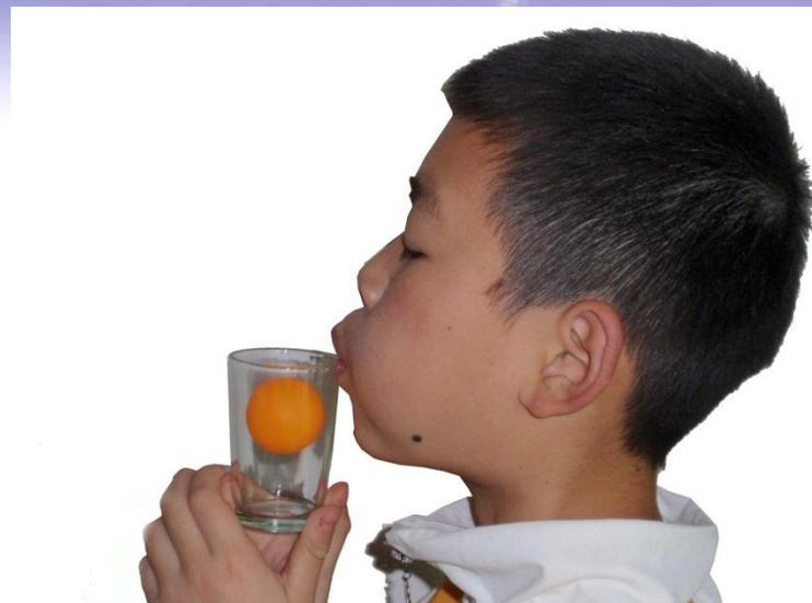
水平吹气使乒乓球上方气体流速大，压强小；下方气体流速小，压强大，这个压强差便形成了乒乓球的升力，当升力大于球重力时，乒乓球上升。
